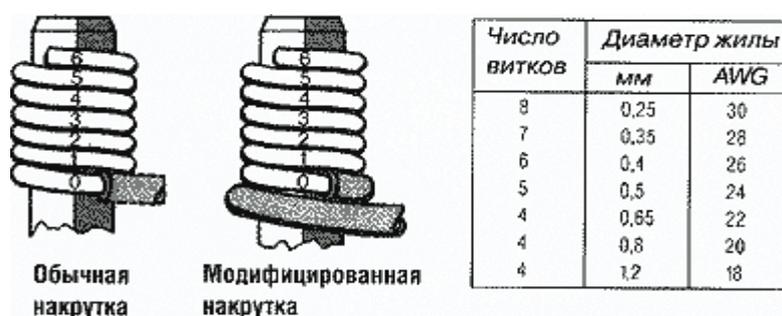
Рис. 4.6. Монтаж накруткой.
