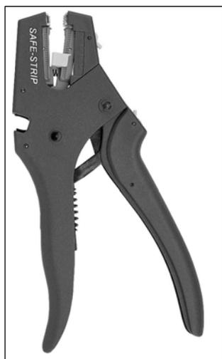
Инструмент для обрезки проводов и снятия изоляции точно адаптируется под площадь сечения кабеля, изолирующего материала и диаметр кабеля. Безопасность и точность гарантируется в диапазоне от 0.08 до 16 мм<sup>2</sup>. Инструменты самонастраивающиеся и оснащены встроенным боковым резом.
