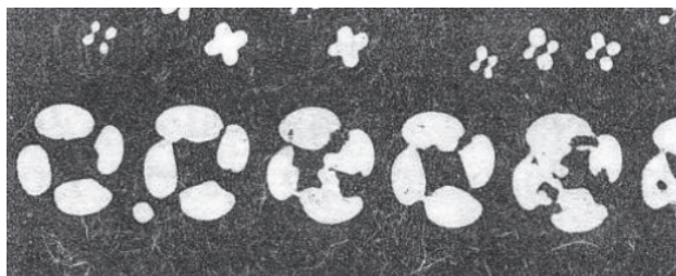
Рис. 15.21. Визуализация контактных окон ИС с помощью НЖК, 120х
