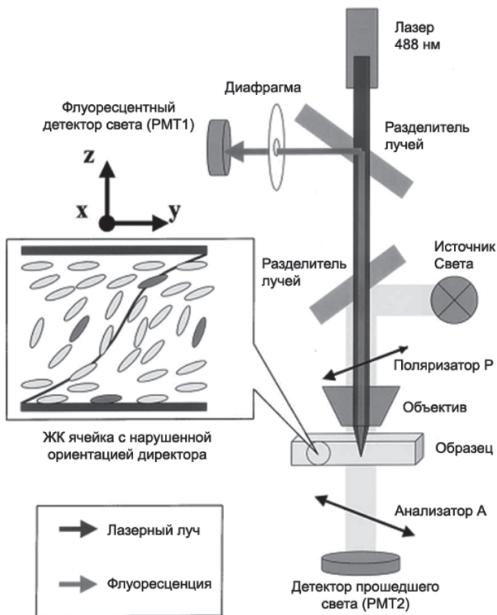
Рис. 3.36. Принципиальная схема ФКПМ для изучения ориентации ЖК в объеме.
