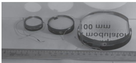
Рис. 12.4. Семейство модуляторов с апертурой от 30 до 100 мм, осуществляющих запись голографических решеток в видимом диапазоне длин волн с амплитудой 2\pi и числом интерференционных полос 2000–3000
