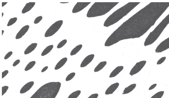
Рис. 15.17. Статическая 180-градусная доменная структура монокристалла ТГС, визуализируемая слоем НЖК на сколе (010), 100х
