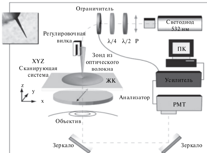
Рис. 3.34. Принципиальная схема установки для сканирования зонда микроскопа сверхвысокого разрешения относительно слоя НЖК
