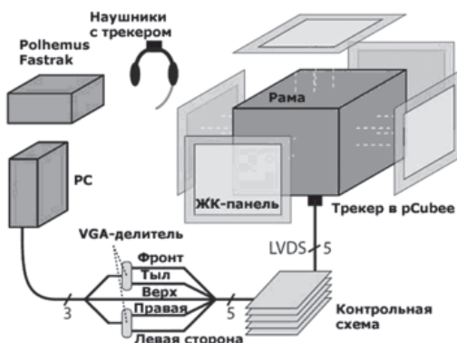
Рис. 8.35. Схема pCube дисплея [79]
