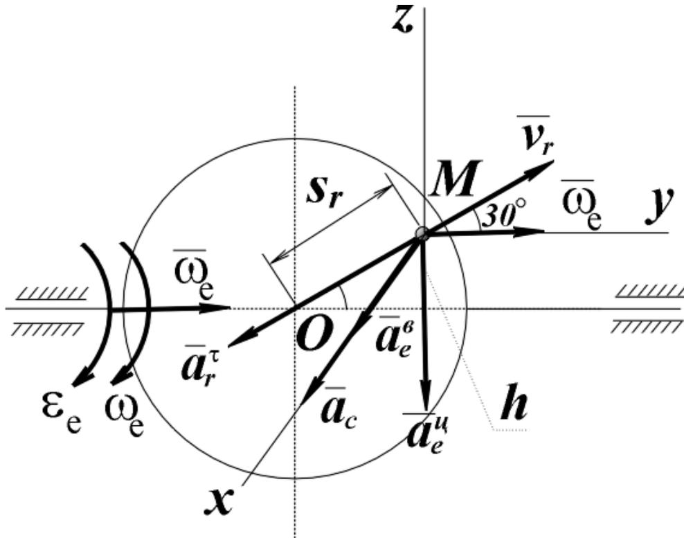
Рис. 21. Определение абсолютного ускорения точки  $M$ .
