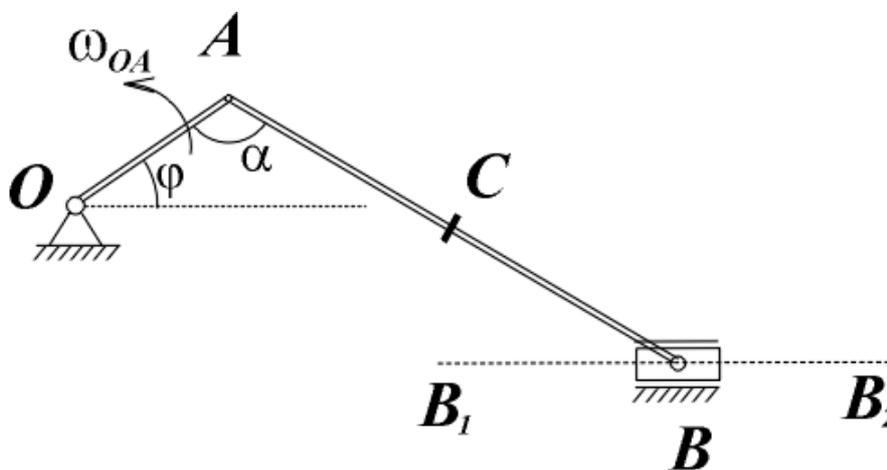
Рис 16. Параметры заданного положения и движения Кривошипно-ползунного механизма.
