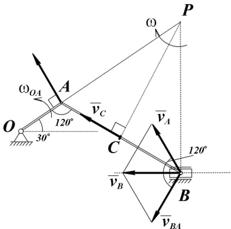
Рис 17. Определение скоростей точек B и C.
