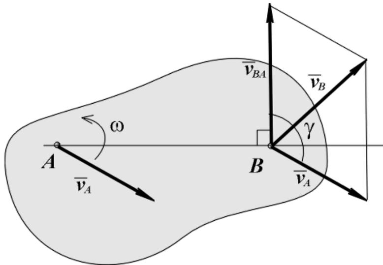
Рис 9. Определение скорости точки  $B$  с использованием полюса  $A$ .
