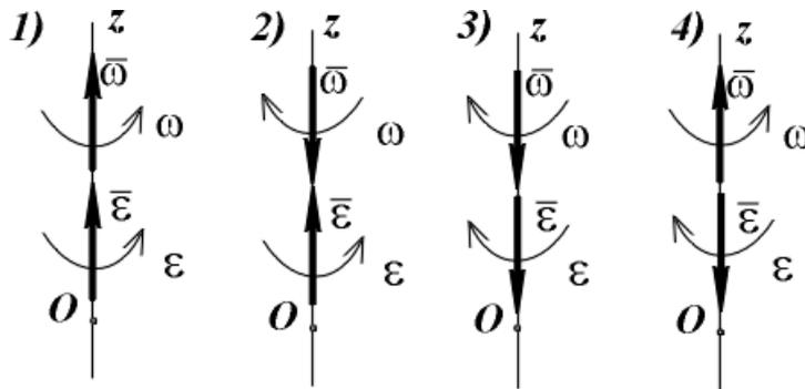
Рис.6. Векторы угловой скорости и углового ускорения вращающегося тела и их взаимное расположение.
